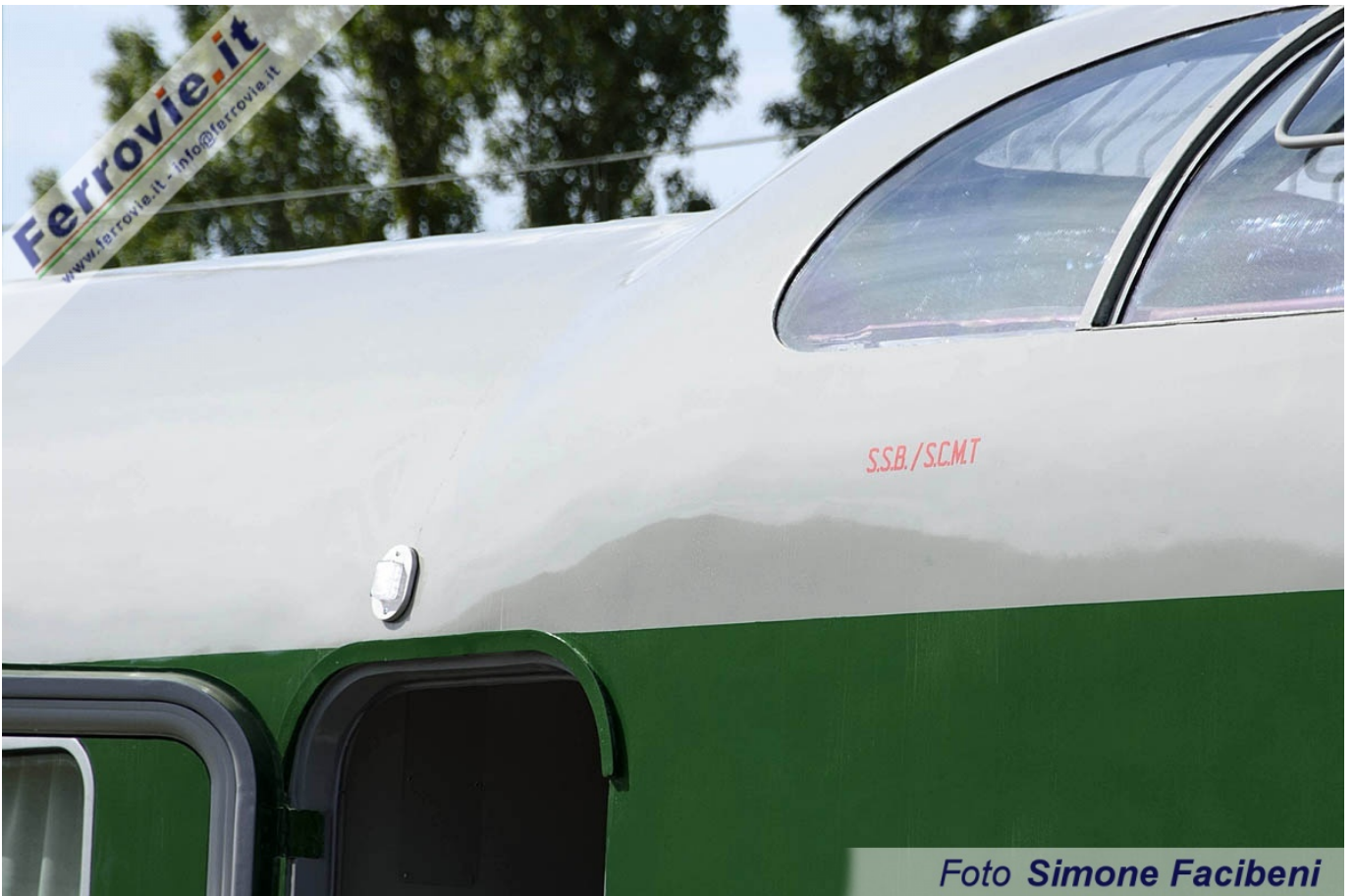
Particolare della scritta in rosso, posta al di sotto dei finestrini della cabina rialzata, indicante la presenza a bordo del sistema SCMT e del led bianco relativo al circuito di lateralizzazione e blocco porte. Foto Simone Facibeni - 21 giugno 2019
